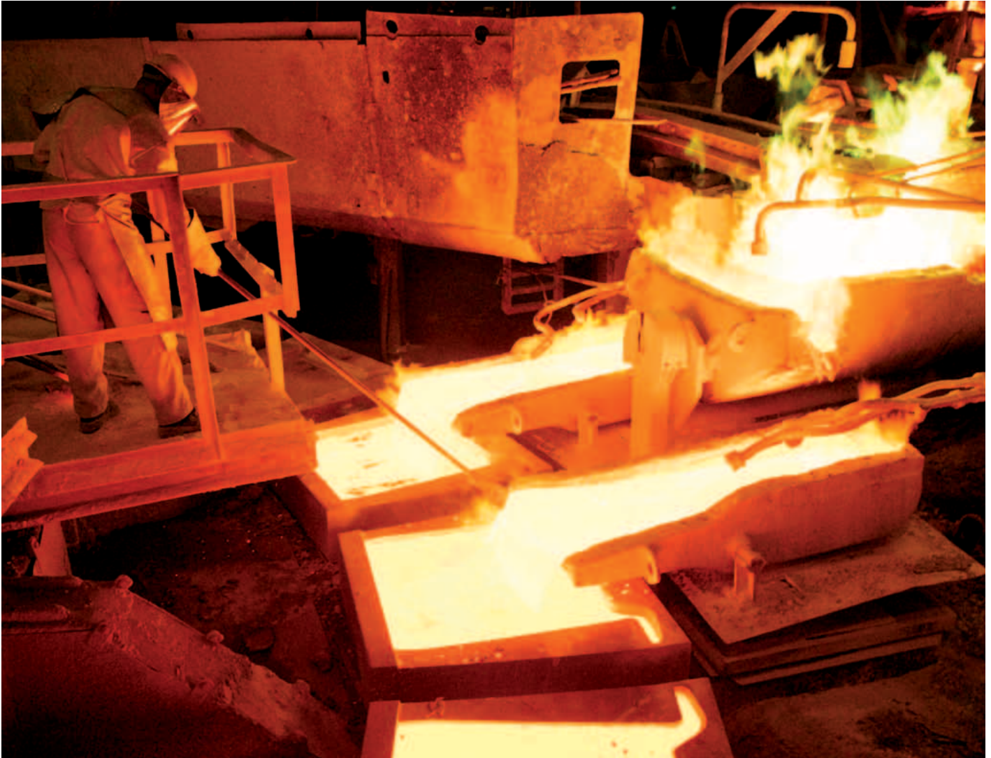
Heißer Job: Ein Arbeiter leitet 1.220 Grad heißes, flüssiges Kupfer in das Anodengießrad
