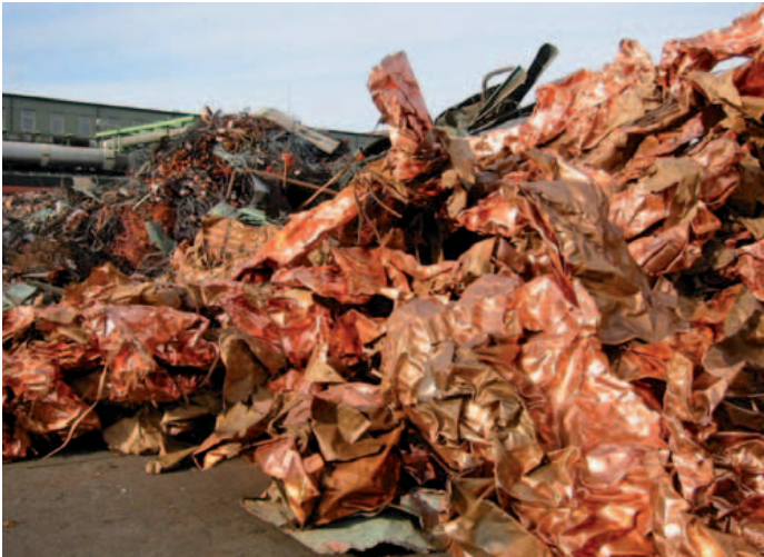
Fertig zum Recyclen: Folienschrott mit 90 bis 95 % Kupfer
