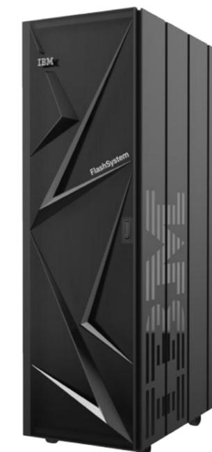
Das IBM FlashSystem 9200R ist ein von IBM montiertes, getestetes und vollständig konfiguriertes 9200-Modell, das durch zwei Brocade- oder Cisco-Switche im Rack verbunden ist. So besteht die Möglichkeit, 2- (9202R), 3- (9203R) oder 4-Wege-Systeme (9204R) auf Basis des 9200-Speichers einzusetzen. Im Maximal-Ausbau erreicht das System eine Leistung von bis zu 17 Millionen IO/s und bis zu 180 GB/s Durchsatz: **Ein Speicher-Kraftpaket der Extra-Klasse!**
